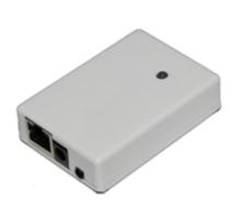
Pour contrôler les équipements infra-rouges, Soline utilise une télécommande universelle pilotable par le réseau informatique. Une telle télécommande peut commander tous les équipements qui sont dans son champ de vision ou jusqu'à six équipements différents si le module est «caché» dans une armoire. L'utilisateur peut ainsi la commander avec des commandes aussi simples que «Soline, je veux regarder TF1» ou «Soline, chaîne suivante».
